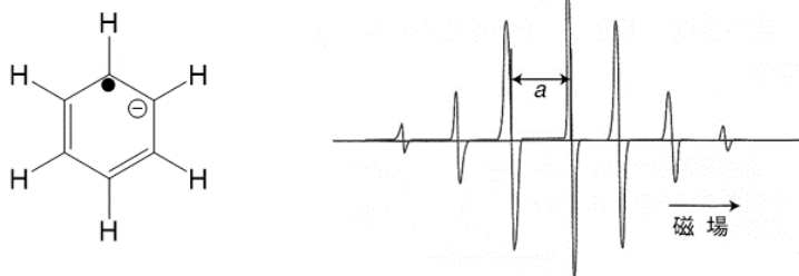
図 11-22 ベンゼンアニオンラジカル 74 の溶液中の EPR スペクトル。6 個の H 原子核スピンが共鳴条件の吸収ピークの分裂を引き起こし、強度比が 1:6:15:20:15:6:1 の 7 本のピークがスペクトルに表れている ( a は超微細結合定数で 0.375 mT)。
