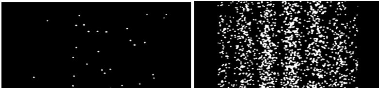
図 3-3 光が 2 重スリットを通過した後スクリーンに映し出される様子。極めて小さい光量の場合（左）と光量を増した場合（右）。
