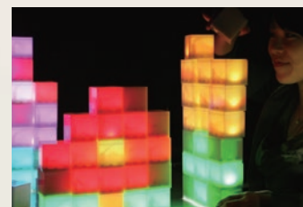
(図2)手でつかんで積み上げるピクセル。次世代証明や玩具、立体形状ディスプレイとしての応用が期待される
