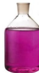
可視光線領域のエネルギーを吸収できるエネルギー差をもつ HOMO-LUMO の組み合わせを考えると、 $O^{2-}$  の 2p 軌道に由来する分子軌道と Mn の 3d 軌道に由来する分子軌道 (e 軌道と  $t_2$  軌道) となる。
