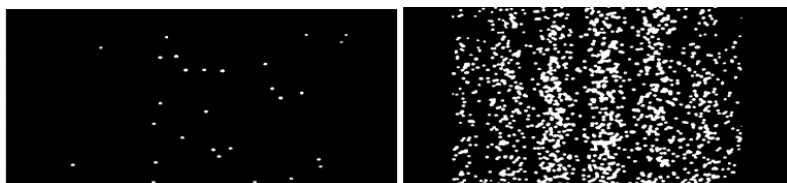
図 3-3 光が 2 重スリットを通過した後にスクリーンに映し出される様子。極めて小さい光量の場合（左）と光量を増した場合（右）。
