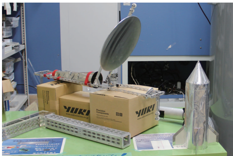
図3：柏のオープンキャンパスでの展示 図中右から、実際に打ち上げ実験に用いたロケット 箱上にあるのは長距離照射が可能なパラボラ集光ミラーを搭載したモデル 左下はリード弁吸気機構のついたモデル
