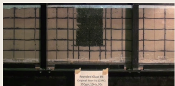
(図2) 下水道管模型を作製し、擬似的に地震を引き起こすことで耐震性の向上を観察している様子
