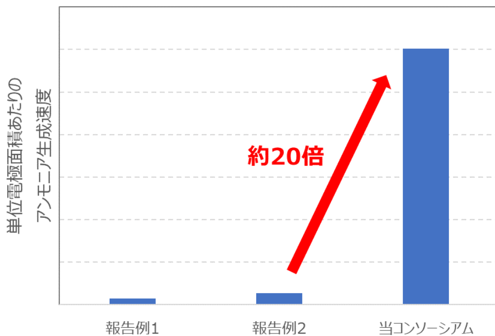
図1. 常温・常圧下、窒素・水・電気を用いたアンモニア電解合成反応の性能値比較 報告例1 : S. Zhang, H. Zhao ら, Angew. Chem. Int. Ed. , 59, 13423 (2020) 報告例2 : S. Zhang, H. Zhao ら, Nat. Sustain. , 6, 169 (2023)
