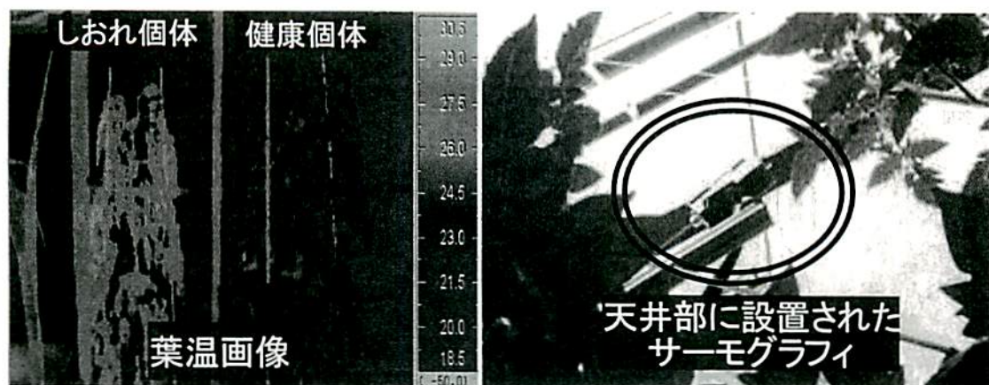
図2 葉温画像によるトマト個体の蒸散機能モニタリングの例(左)と太陽光利用型植物工場内に設置されたサーモグラフィ(右:オランダ)
