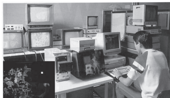
写真3 1987年当時の自然環境シミュレータ制御室に設置された植物機能の画像計測処理システム。左下は、光合成機能診断のためのLIFT(Laser Induced Fluorescence Transients)イメージングシステムによる植物計測の例。
