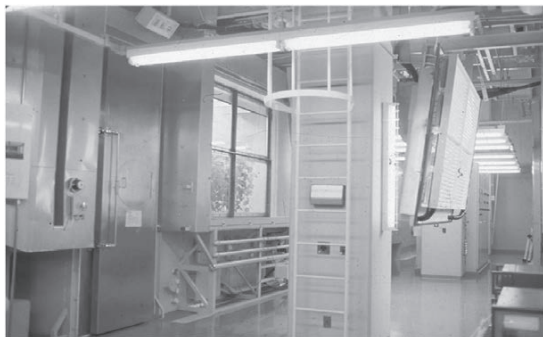
写真2 ファイトロン II 棟に設置された大型風洞タイプの自然環境シミュレータ。
