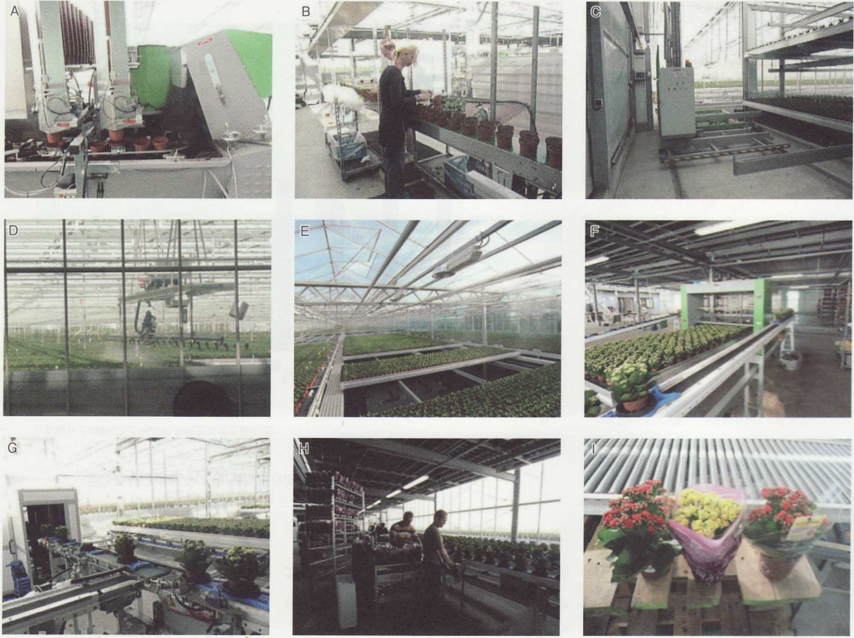
A: 人工土壌（ピートモス）の鉢詰め, B: 植え付け, C: 栽培コンテナの移動, D: 培養液の自動散布, E: ハウス内での細霧冷房, F: 栽培コンテナからベルトコンベア上のIDチップ付きパレットへの鉢の移し換え, G: マルチカメラの画像計測装置による選別, H: 鉢花の包装, I: 包装された鉢花
