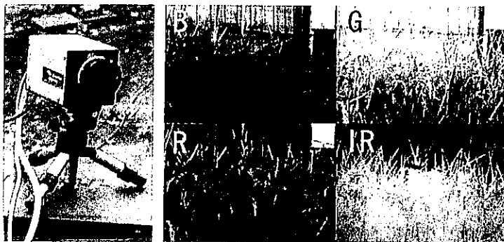
(図一九) 分光ミラー/フィルタ内蔵のマルチスペクトルカメラ (DuncanTech MS3100) と計測されたイネのスペクトル画像。B: 0.40~0.52 \mu\text{m} 、G: 0.48~0.60 \mu\text{m} 、R: 0.60~0.72 \mu\text{m} 、NIR: 0.70~1.1 \mu\text{m} 。
