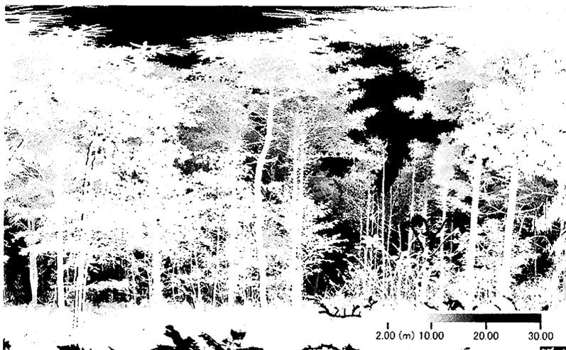
図10 可搬型SLを用いたカラマツ林の距離画像の計測例<sup>11)</sup>
