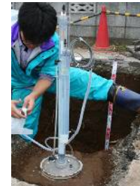
負圧浸入計を用いた現場透水性の評価
