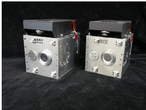
図 2 2022年打上げ予定の水推進機
