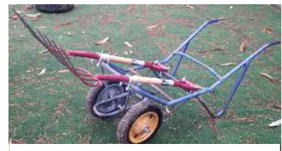
一輪車を改造した水草収集車
